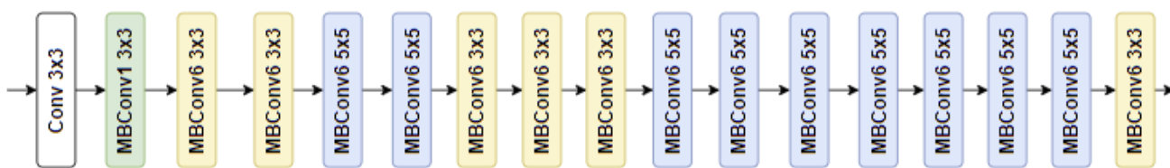
31 pav. EfficientNetB0 tinklo architektūra [24]
