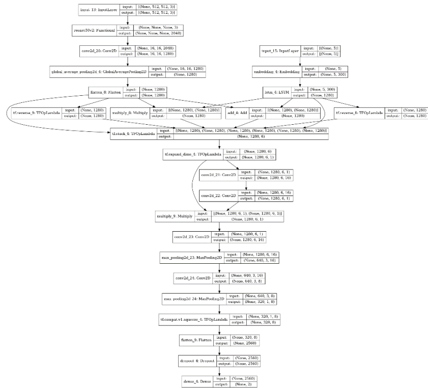
71 pav. LSTM ir ResNet50v2 architektūra (taikant sąsūką bei svorius požymiams)
