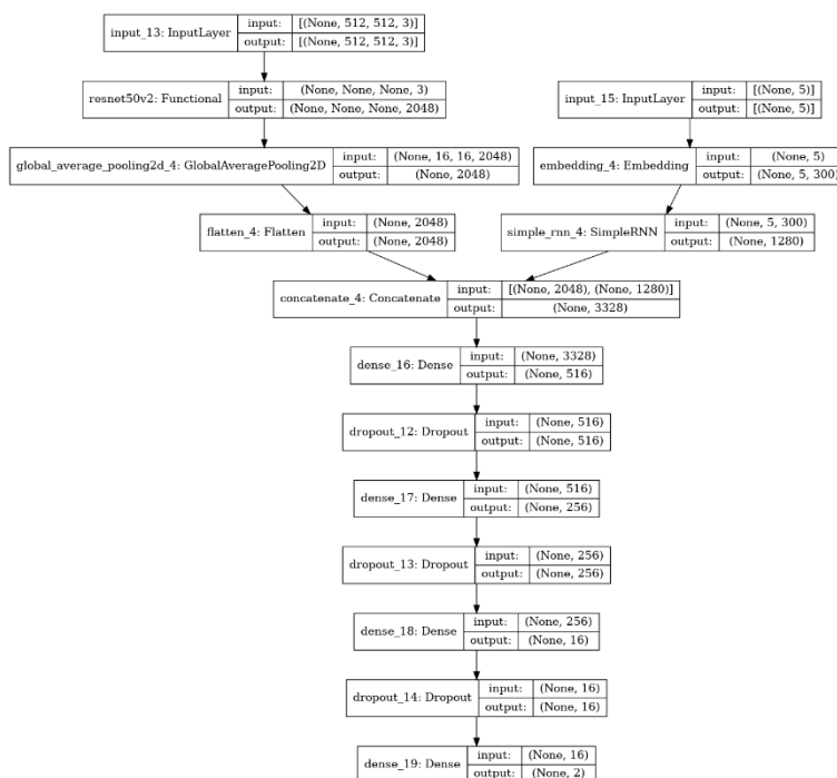
50 pav. RNN ir ResNet50V2 architektūra (konkatenuojant požymius)
