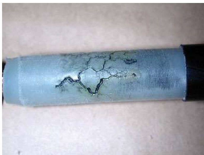
16 pav. Blogai sumontuotos jungiamosios movos pasekmės [21]
