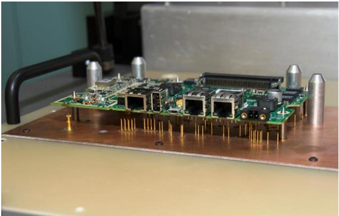
8 pav. DUT prijungto prie testavimo adatų iliustracija
