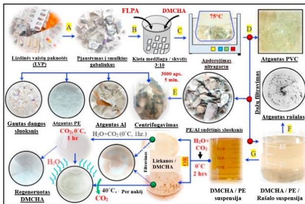
2 pav. Lizdinių vaistų pakuočių atliekų apdorojimo schema
