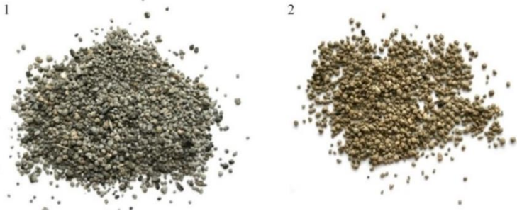
3.8 pav. Granuliuotų biomasės pelenų atskirų bandinių optinės mikroskopijos nuotraukos ( \times 12 ): 1 – produktas, gautas granuliuojant pelenus, 2 – produktas, gautas granuliuojant pelenų ir defekato mišinį
