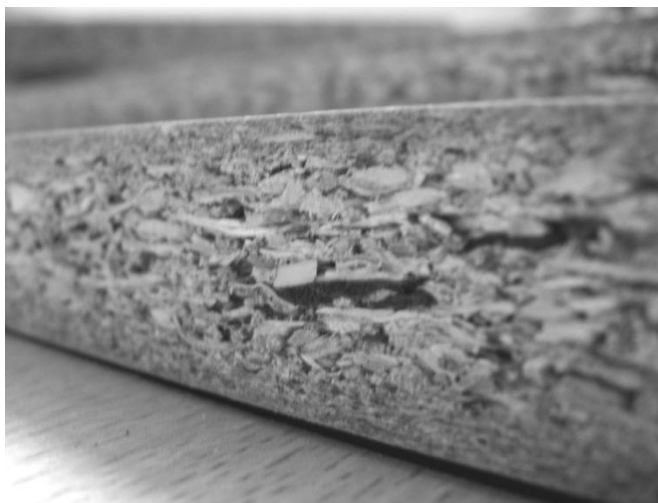
Рисунок 1 – Неодинаковая плотность ДСтП по толщине
