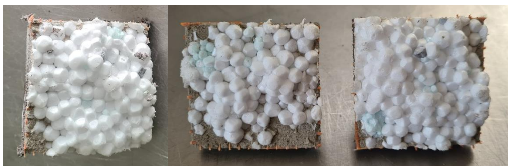
65 pav. Nuo kairės - bandinio A plokštelė po 0, 12, 24 parų UV spindulių poveikio
