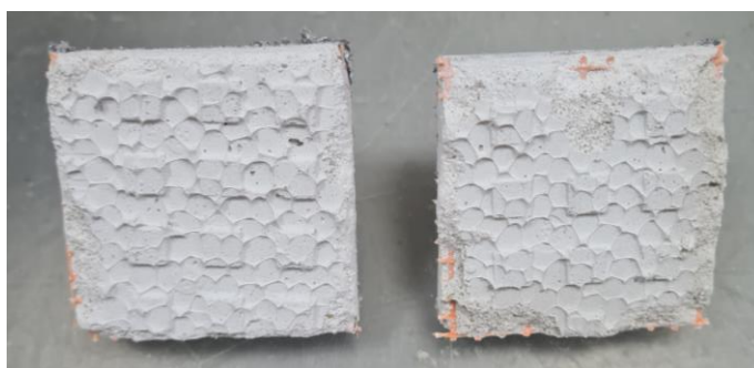
60 pav. Nuo kairės - bandinio B plokštelės po mirkymo vandenyje ir džiovavimo 23\pm 2^{\circ}\text{C} 2 valandas; 7 paras
