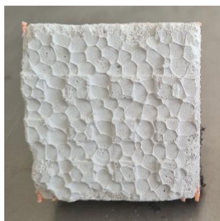
57 pav. Bandinio B plokštelė nutraukta po žemos temperatūros poveikio
