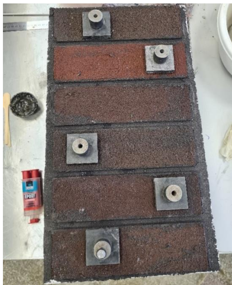
55 pav. Ant bandinio suklijuotos metalinės traukimo plokštelės
