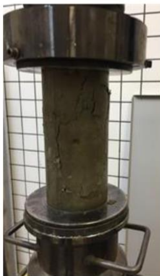
14 pav. Bandinys testuojamas su gniuždymo mechanizmu [6]
