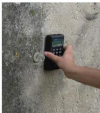
3 pav. „Įvertinimo vietoje“ drėgmės matavimas matuokliu „Tramex Survey Encounter“ [2]
