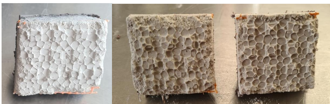
63 pav. Nuo kairės – bandinio B plokštelė po 40, 80 užšaldymo-atšildymo ciklų
