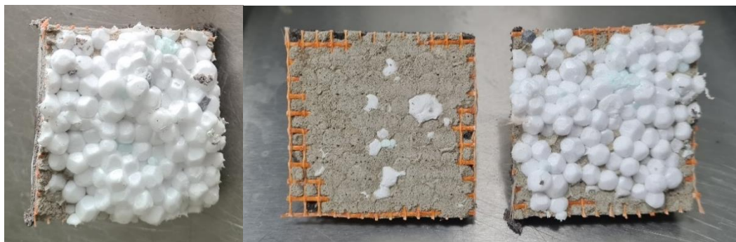
62 pav. Nuo kairės – bandinio A plokštelė po 0, 40, 80 užšaldymo-atšildymo ciklų
