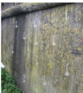
2 pav. „Įvertinimo vietoje“ „Karsten“ vamzdelių metodas [2]
