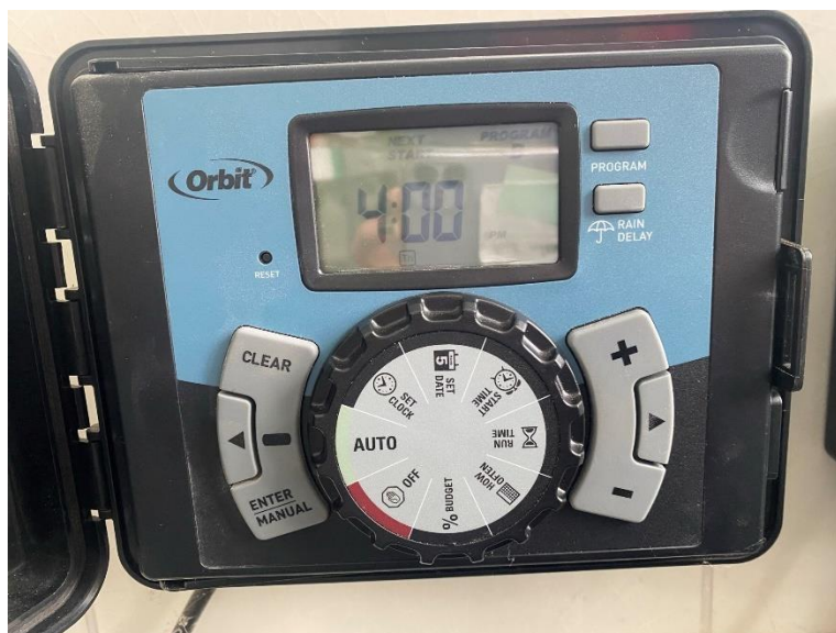
49 pav. Laistymo sistemos valdiklis.
