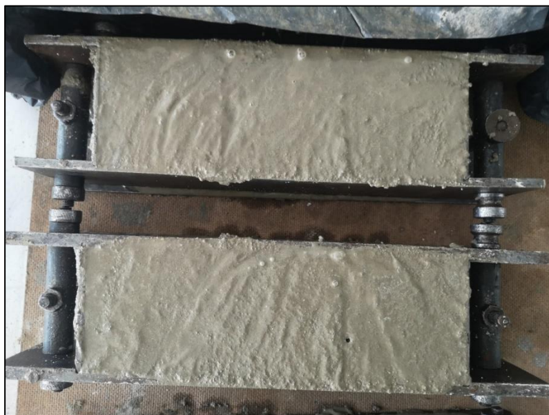
10 pav. Cemento tešla paruošta kietėjimui klojiniuose
