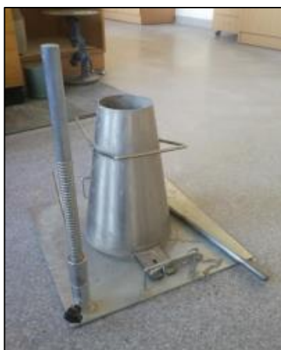
11 pav. Betono mišinio slankumo nustatymui naudojama įranga
