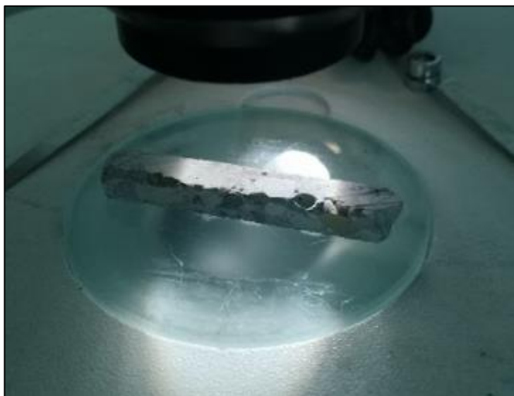
19 pav. Mikroskopu tiriamas išpjautas bandinys
