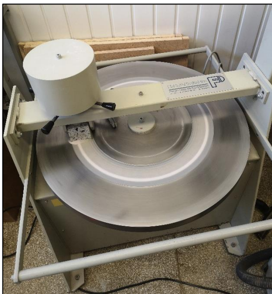
16 pav. Atsparumo dėvėjimuisi nustatymo įrenginys
