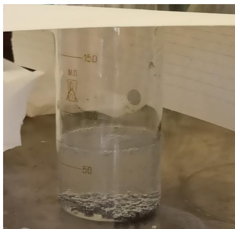
14 pav. Vykstanti titano dioksido sintezė peroksidiniu metodu.
