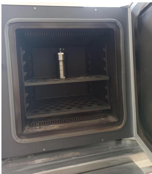
17 pav. Nano titano dioksido kristalų auginimas autoklave
