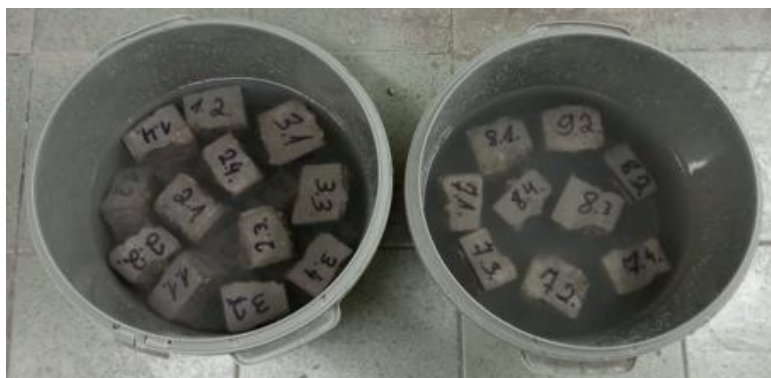
40 pav. Talpos skirtos betoninių bandinių įmirkymui
