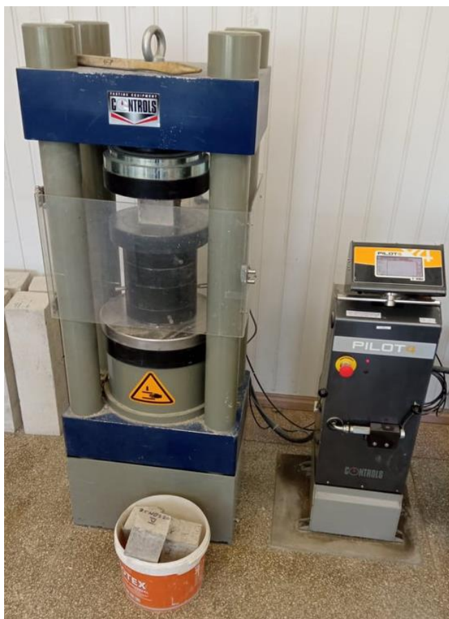
37 pav. Gniuždymo stiprio nustatymas po 28 dienų
