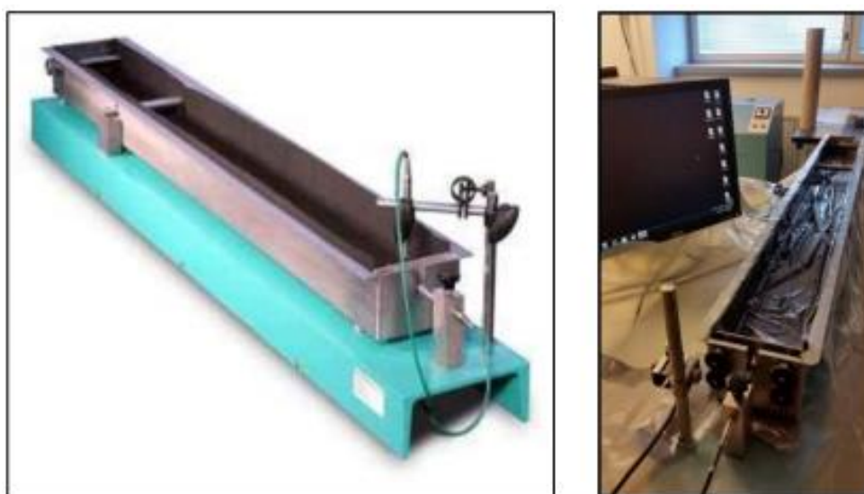
3 pav. Savaiminio susitraukimo bandymas naudojant Schleibinger Bending-Drain įrangą [23]
