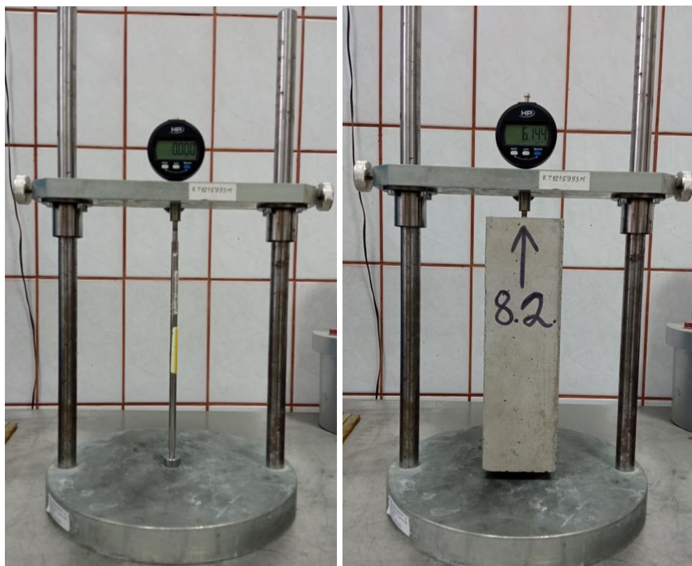
33 pav. Sudėties nr.8 (CaO1.5SRA1.5) susitraukimų matavimas po 90 dienų
