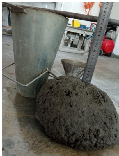
31 pav. Sudėties nr.6 (CaO1.5) suslūgimas
