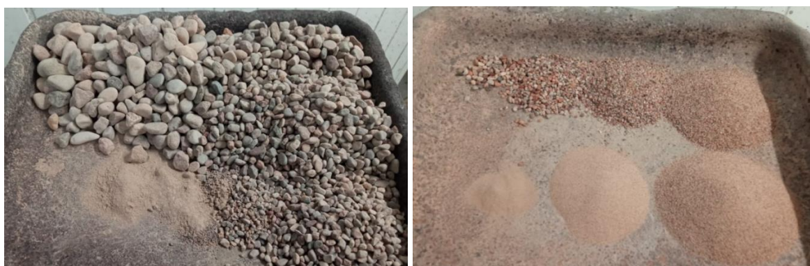
28 pav. Išsijotų užpildų frakcijos (a) – žvirgždas fr. 4/16, (b) – smėlis fr. 0/4
