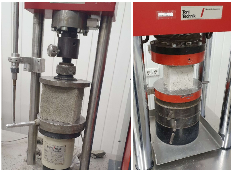
13 pav. Gniuždymo presai „Toni Technik“
