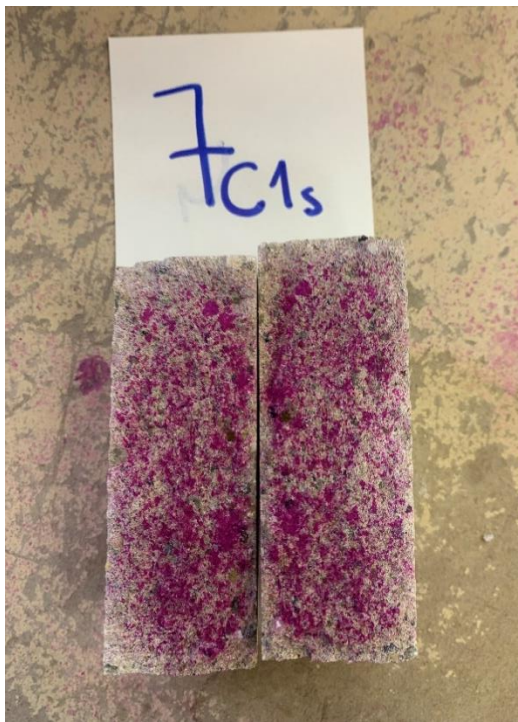
35 pav. 7 c1 bandinio karbonizacijos gylis
