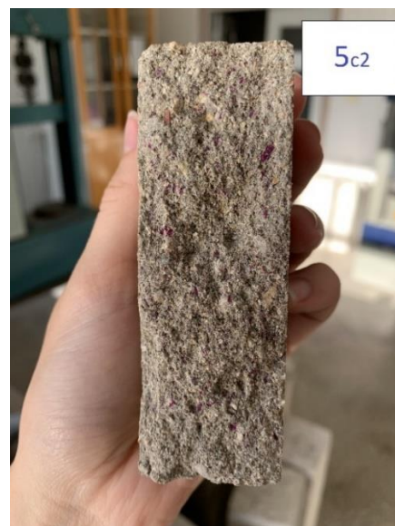
32 pav. 5_{c2} bandinio karbonizacijos gylis
