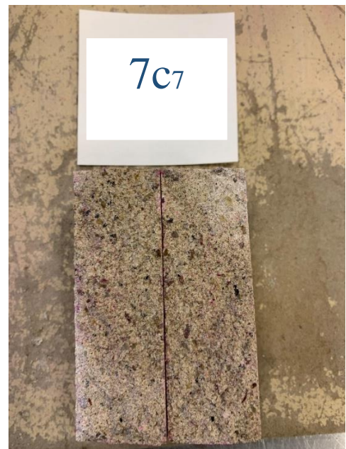
38 pav. 7 c7 bandinio karbonizacijos gylis
