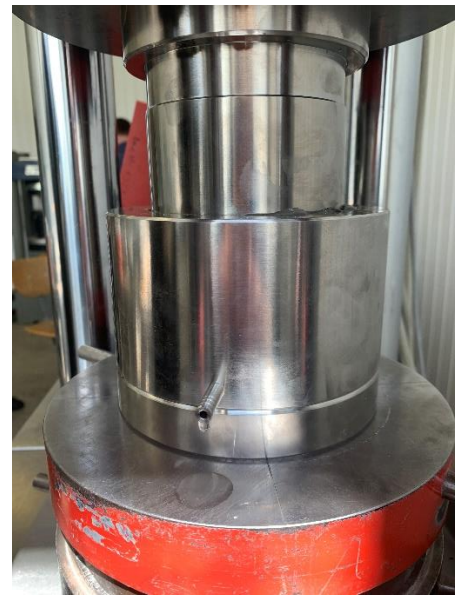
15 pav. Perteklinio vandens lašėjimas iš presavimo formos
