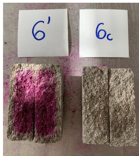
30 pav. 6' ir 6c karbonizacijos gylis
