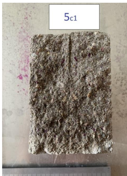
31 pav. 5_{c1} bandinio karbonizacijos gylis
