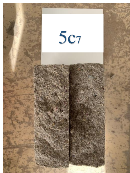
34 pav. 5_{c7} bandinio karbonizacijos gylis
