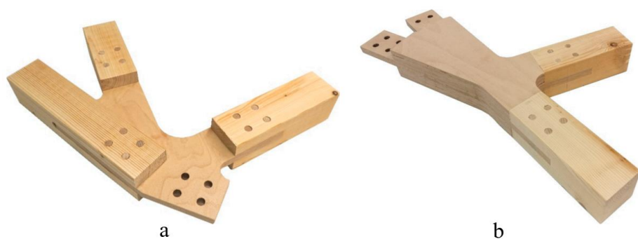
7 pav. Santvaros mazgų jungtys: a – tempimo mazgas; b – suspaudimo mazgas su užpildytu skerspjūviu [10]
