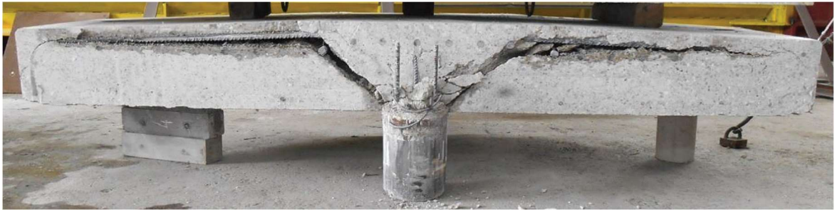
7 pav. Perpjauta perdangos plokštė be skersinio armavimo [4]
