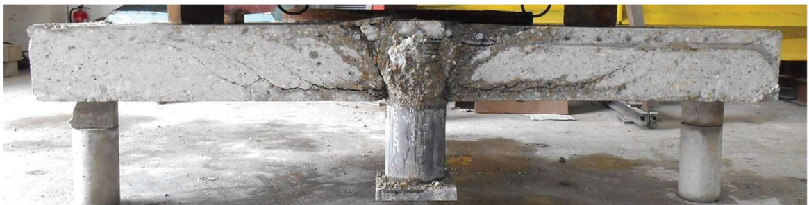
8 pav. Perpjauta perdangos plokštė su skersiniu armavimu [4]
