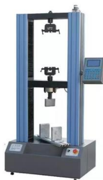
29 pav. Atsparumo gniuždymui matavimo įranga
