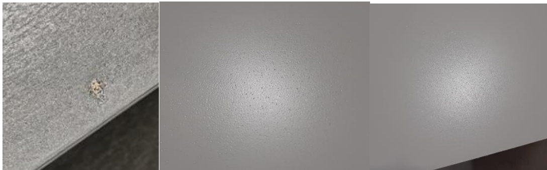
52 pav. Neužpildymo defektai. a) mechaninis pažeidimas pagamintas 2 būdu; b) neužpildymo defektai ant detalių, kurios pagamintos 3 būdu
