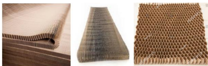
4 pav. Popierinio korinio būsenos kitimas iki pilno išdžiovinimo [14]
