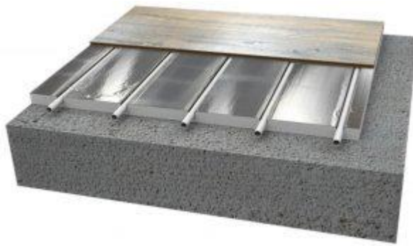
4 pav. Sauso tipo grindinio šildymo sistemos konstrukcija [19].
