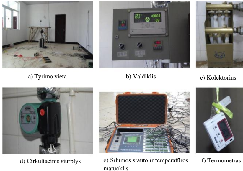
7 pav. Laboratorija ir įranga naudota tyrime [25].
