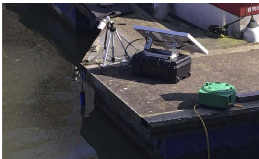
2 pav. Belaidė vandens kokybės stebėjimo sistema [1]
