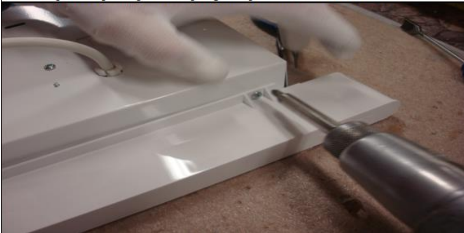
24. Dešinė paruošta panelė prisukama prie galinės plokštės dviem 11118 varžteliais.
