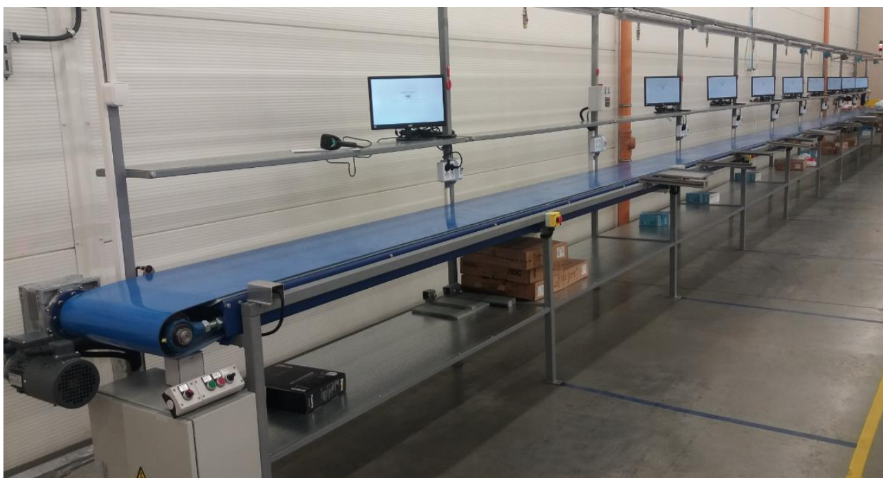
9 pav. Modernizuotas šildytuvų surinkimo konvejeris
