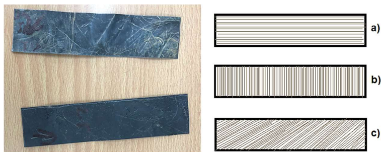
22 pav. Pagaminti bandiniai, kuriuose pluoštas orientuotas: a) išilgai bandinio; b) skersai bandinio; c) 45° kampu.
