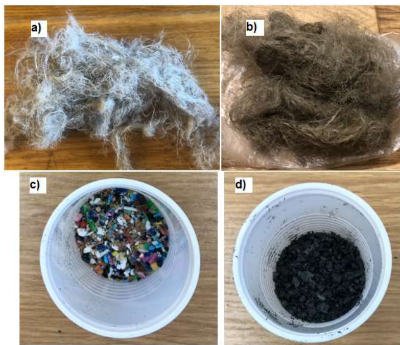
17 pav. Kompozito gamybai naudotos žaliavos: a) K1; b) K2; c) PP; d) PE
