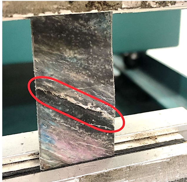
23 pav. Nutrūkęs bandinys tempimo įrenginyje
