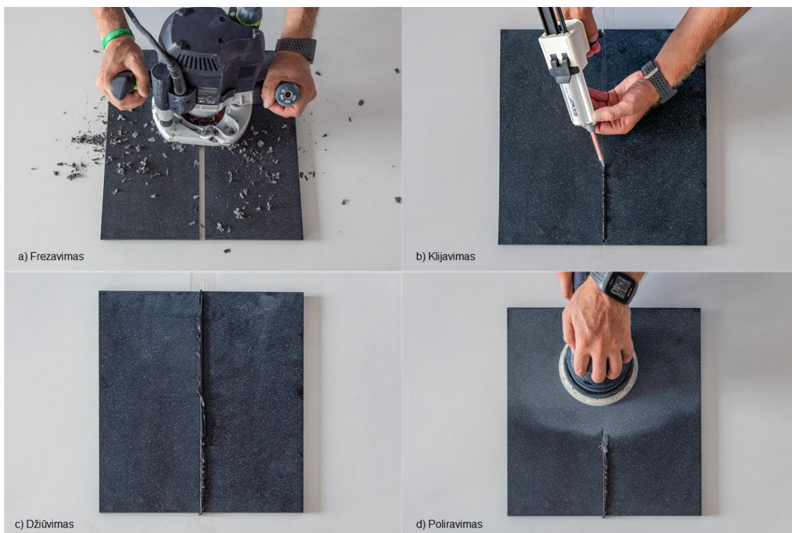
11 pav. Dirbtinio lieto akmens klijavimo proceso etapai: a) klijavimo vietos nulyginimas; b) klijavimas; c) klijų džiovinimas; d) šlifavimas ir poliravimas
