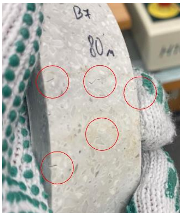
21 pav. Raštuotas dirbtinis lietas akmuo po lenkimo bandymo 170 °C temperatūroje (skilimai pažymėti raudonai)
