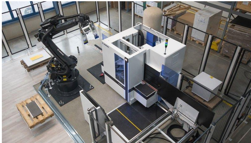
34 pav. Automatizuotas kompiuterizuoto frezavimo kompleksas [34]
