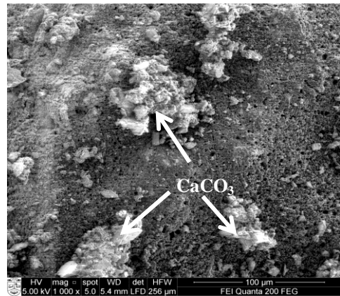
b) Silikatinio-silikoninio tinko paviršiuje matomos atviro poros ir kalcito kristalai
