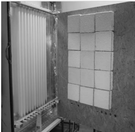
2.5 pav. ITSTS bandiniai UV spinduliuotės klimatinėje kameroje
