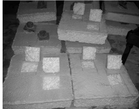
3.19 pav. Bandinių po dviejų dirbtinio (kairėje) ir natūrinio (dešinėje) sendinimo metu atplėšimo pobūdis
