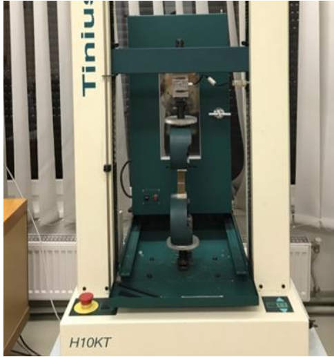
Fig. 2 Tensile test on Tinius Olsen H10KT
